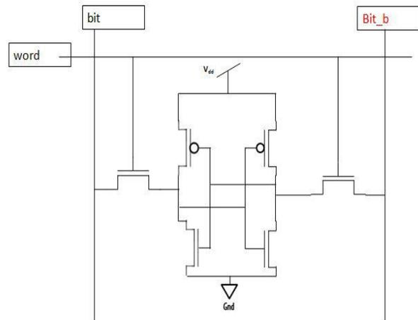
Fig. 9. 6T SRAM cell
